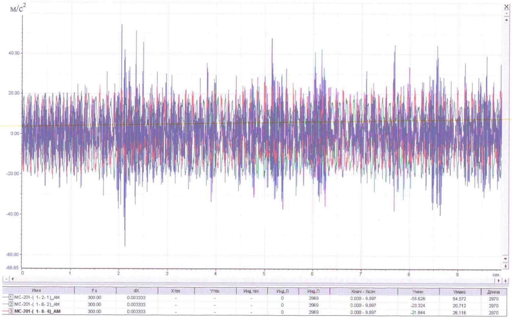
Рис. П-1-13. Акселерограммы ( m/s^2 ), записанные с для датчика 1-2-1 (синим цветом), датчика 1-8-2 (зеленым цветом) и датчика 1-8-4 (красным цветом) при 11-м режиме испытаний (частота f=6.7 Гц; амплитуда A=3.5 мм)
