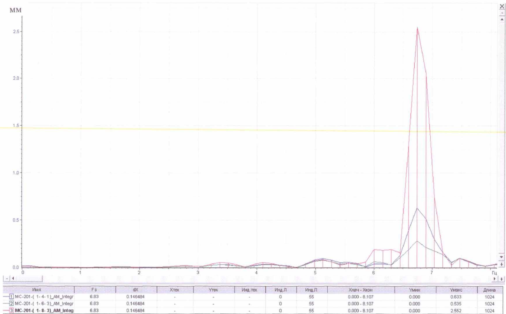
Рис. П-1-18. Спектры пиковых значений амплитуд (мм) для датчика 1-4-1 (синим цветом), датчика 1-6-3 (зеленым цветом) и датчика 1-8-3 (красным цветом) при 11-м режиме испытаний (частота f=6.7 Гц; амплитуда A=3.5 мм)
